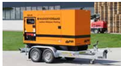
1-Achs/2-Achs-Straßenfahrgestelle Robuste Stahlkonstruktion, feuerverzinkt, auflaufgebremst
