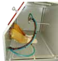
PAL Innenraum (Injektorsystem)
