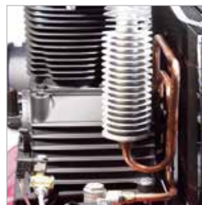
Kühler aus Alu- Druckguss und Kupferkühlleitung
