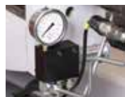
Spanndruckregelung des Spannstockes
