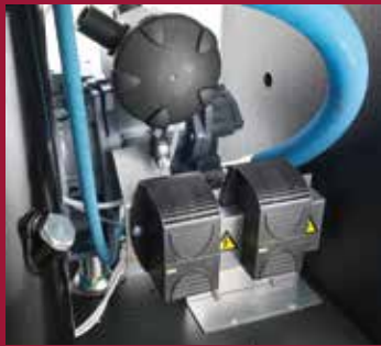
Schalldämmhauben-Heizung: Für Anlagen bei niedriger Umgebungstemperatur
