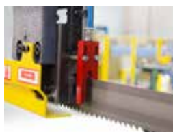
Sägebandführung aus Hartmetall
