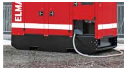
Heavy Duty Baseframe Grundrahmen in Schlittenausführung mit Zug- und Zurrpunkten
