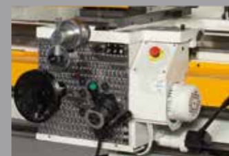
Support-Control Steuerhebel (außer CU 325)
