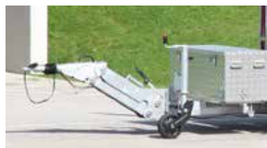
Höhenverstellbare Zugdeichsel Für einfache Anpassung an das Zugfahrzeug
