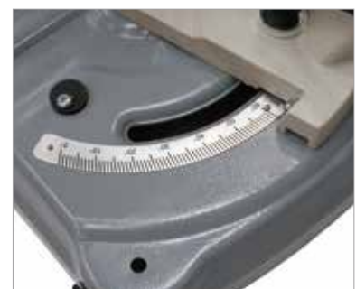
Gut ablesbare Winkelskala - einfache Gehrungseinstellung 0 bis 60°
