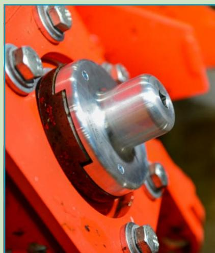
Sicherer Halt durch eingebrachte Magnete
