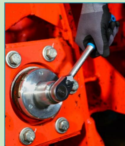
Betätigung mittels Knarre durch eingebrachte 1/2" (12,5 mm) 4kt.-Aufnahme
