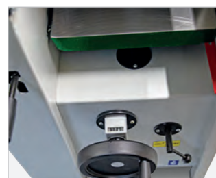
Dicketisch Führung auf mittlerer Säule und Zusatzführung Höhenverstellung über Handrad Höhenanzeige durch mechanisches Zählwerk mit Genauigkeit 0,1 mm
