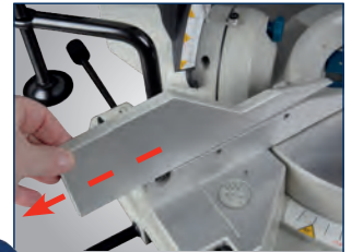
Ausziehbare Anschlagsschienen und ausziehbarer Tisch
