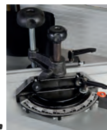
Stufenlos verstellbarer Winkelanschlag
