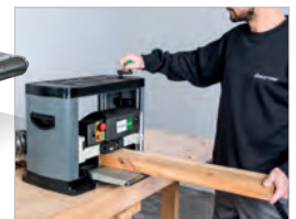
Höheneinstellung über Handkurbel und Skala
