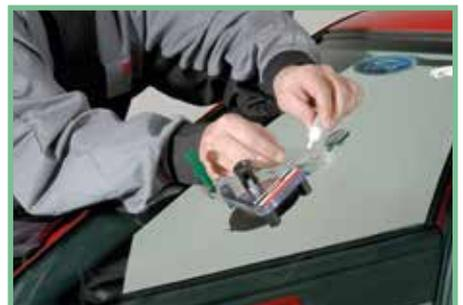
**6** Den Werkzeughalter entfernen und sofort ein 4-5 cm langes Stück Aushärtefolie ohne Druck auf die Reparaturstelle legen. Die Folie leicht anheben und einen Tropfen Finish-Harz auf den Steinschlag geben. Die Folie wieder auf die Scheibe gleiten lassen.
