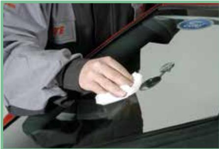
**1** Gelenkspiegel befestigen. Die Fläche mit dem Reinigungstuch oder TEROSON FL + säubern, ohne über die Einschlagstelle zu wischen.
