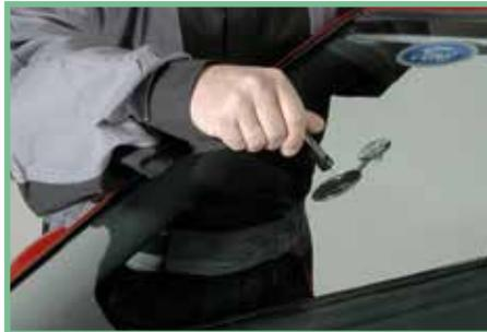
**2** Lose Glassplitter und Verschmutzungen im Steinschlag mit dem Steinschlagöffner entfernen, ohne dabei den Krater unnötig zu vergrößern.
