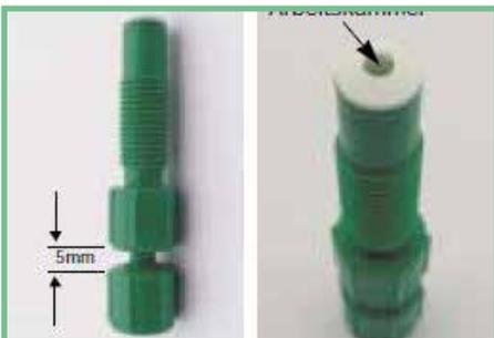
**4** Den Kolben vom Injektor 4-5 mm aus dem Zylinder schrauben. Danach die Arbeitskammer komplett und blasenfrei mit Reparatur-Harz befüllen.
