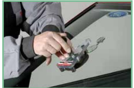
**3** Mit dem Vakuum-Gel die Saugfläche des Werkzeughalters einreiben und so auf der Scheibe befestigen, dass sich die Injektorbohrung genau über der Schadstelle befindet.
