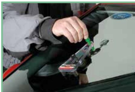
**5** Den Injektor soweit in den Werkzeughalter eindrehen bis die Injektordichtung fest an der Scheibe anliegt. Den Kolben in den Injektor schrauben. Durch den entstehenden Druck wird das Reparatur-Harz in die Schadstelle gepresst. Einige Zeit so stehen lassen.
