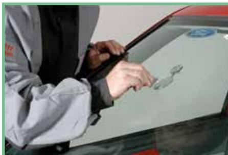
**8** Die Aushärtefolie abziehen. Mit der Bügelklinge im 90 ° Winkel das Material abschaben.
