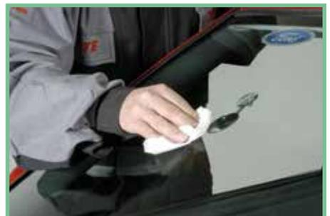
**9** Mit etwas Politur unter leichtem Druck polieren. Nach Beendigung der Reparatur alle Teile mit dem Reinigungstuch reinigen und Restinhalt aus dem Injektor entfernen.
