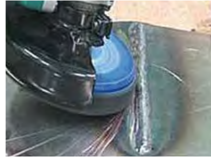
Entfernen von Verfärbungen
