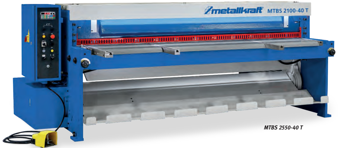
▶ Rückraumsicherung nach CE mit Seitenblechen und Lichtschanke
