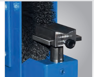
▶ Mit verstellbarer Prismen Werkstückauflage
