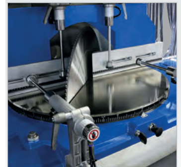
▶ Stufenlose Verstellung des Gehrungswinkels
