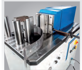
▶ Mit Schnellwechselaufnahme und Seitenanschlag mit Skala
