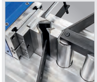
▶ Mit Schnellwechselaufnahme und Seitenanschlag mit Skala
