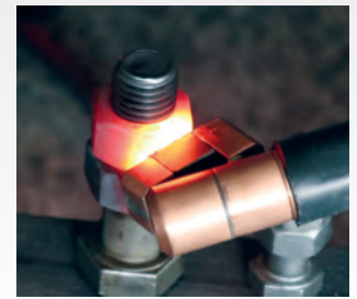
› Erwärmen einer Mutter mit der Fokusspule schräg
