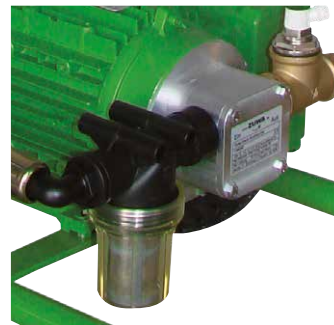
Pumpe mit Filter
